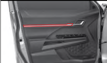
Ambientebeleuchtung an der Verkleidung der Vordertür
